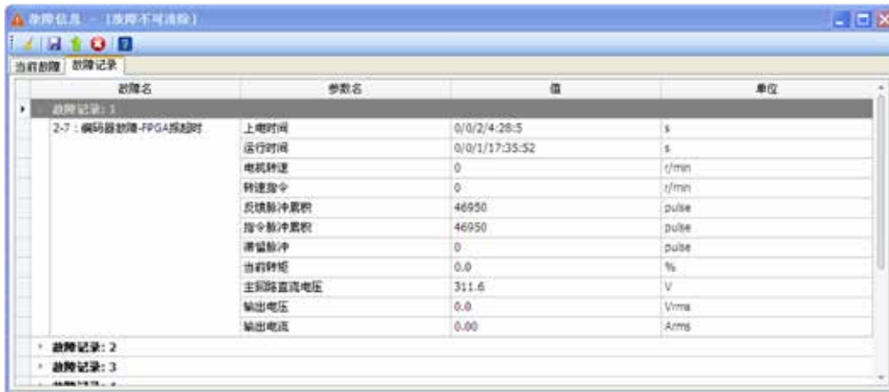
实时故障信息显示及故障记录信息读取
